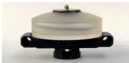
Abb. 3: Die Kompensator-Dose aus Glas mit einem Teil der Abbildungsoptik (unten) und dem Einfüllstutzen für die Flüssigkeit (oben).
