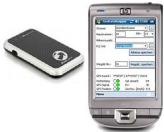
Bluetooth-GPS-Empfänger und PDA mit GeoDataSnapper-Software.
