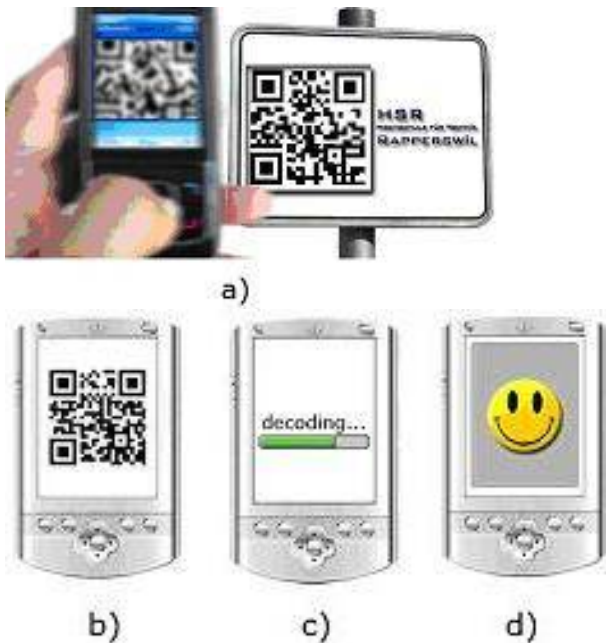
Abb. 1: Funktionsweise des Mobile Taggings am Beispiel eines QR-Codes, der auf einer Informationstafel angebracht ist (vgl. Text).
