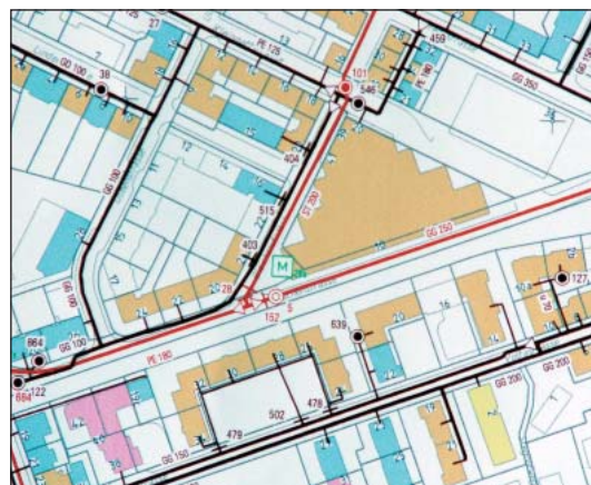
Abb. 3 Übersichtsplan Erdgas mit Gebäudeeinfärbung. Die Farben codieren für Kundengruppen und visualisieren für das Marketing auch indirekte Kunden bei Wärmezentralen.
