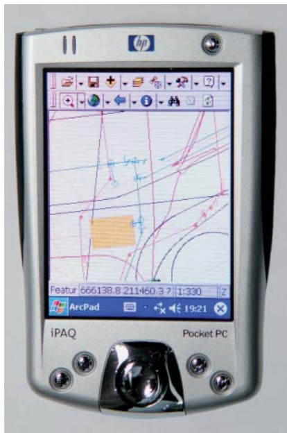
Abb. 5 Westentaschen-WIS auf einem iPAQ. Auftragsleiter oder Netzverantwortliche haben ihre Netzinformationen jederzeit griffbereit und können Auskunft geben oder Massnahmen einleiten.
