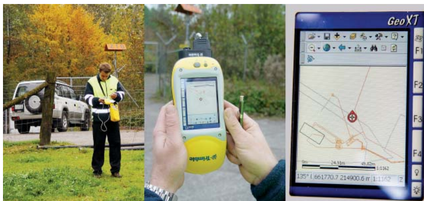
Abb. 6 Trassekontrolle mit einem GeoExplorer. Die Kombination der digitalen Netzpläne mit einem genügend präzisen GPS (DGPS) erlaubt die Trassekontrolle von Hochdruckleitungen weitgehend unabhängig von Flugmarkierungen und Papierplänen. Bei Bauvorhaben kann die kritische Distanz zu den Leitungen effizient kontrolliert werden.
